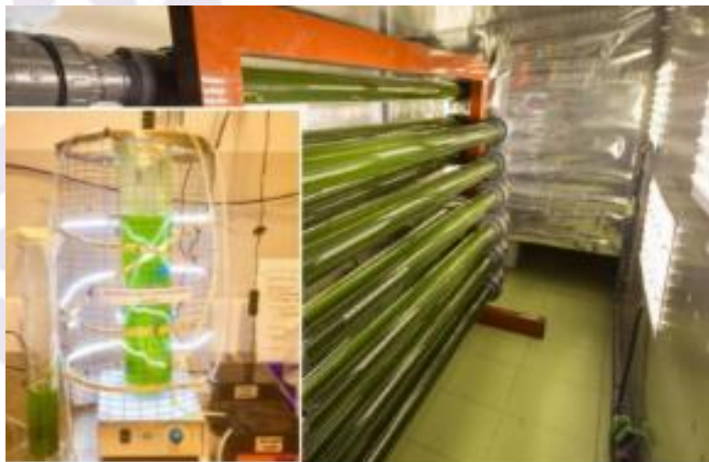
Universidad Valladolid Fotorreactores para el Tratamiento de Aguas Residuales Industriales y Residenciales
